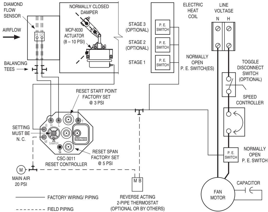
**CONTROL SEQUENCE 4P3 • VAV COOLING WITH ELECTRIC HEAT • REVERSE ACTING/NORMALLY CLOSED (RA/NC) • 3000 CONTROLLER**
