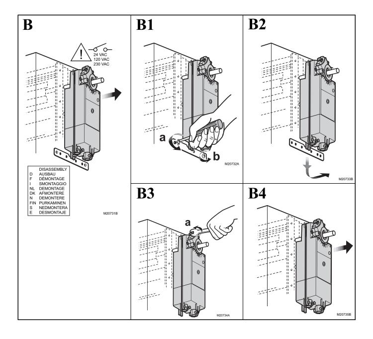
MS4120F; MS4620F; MS8120F; S2024-F; S20230-F FAST-ACTING, TWO-POSITION ACTUATORS
